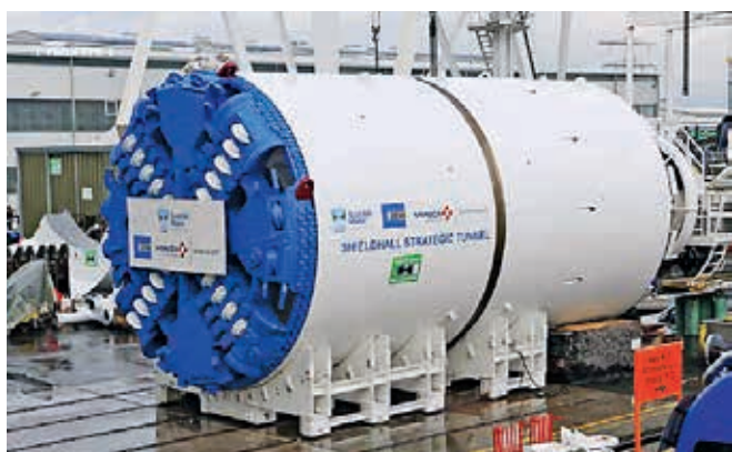
Ryc. 2. Głowica maszyny TBM wykorzystana w Shieldhall Strategic Tunnel w Glasgow
