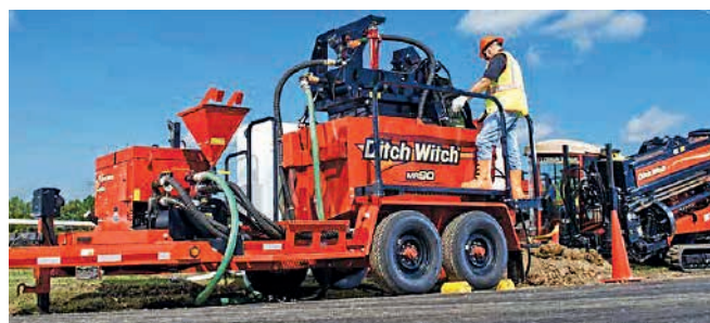
Ryc. 11. Urządzenie do recyklingu płynu wiertniczego firmy DitchWitch
